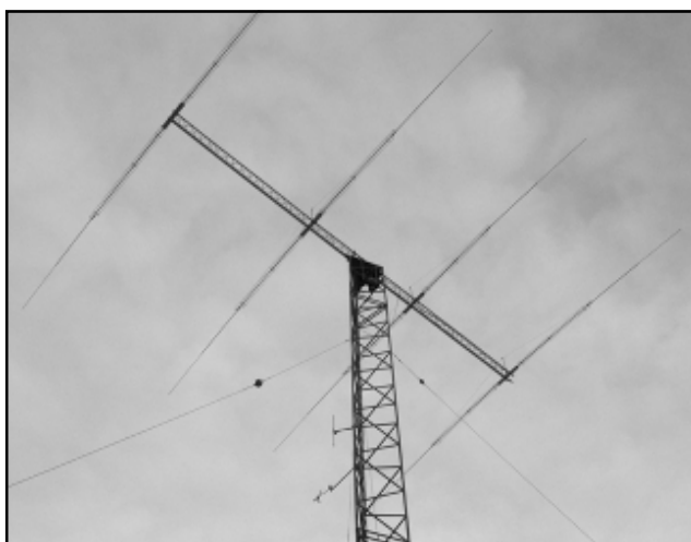
Riktantenn för 40 metersbandet (7MHz). Stor som ett hus
