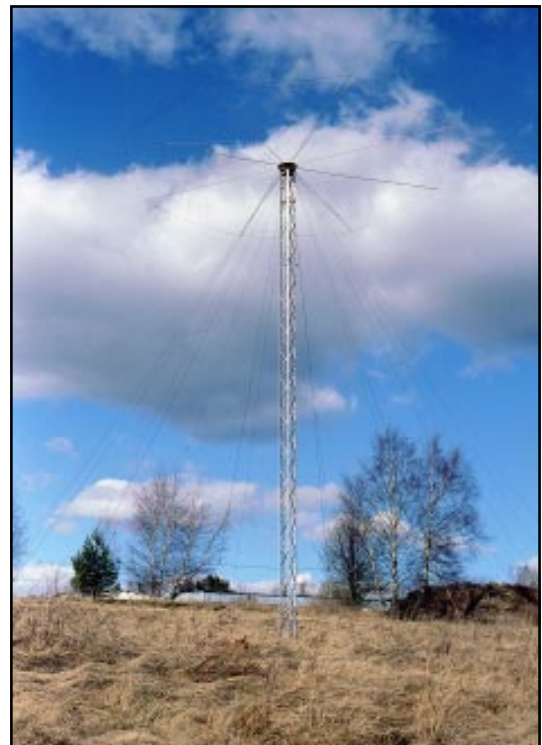
Discone-antenn för 7-30 MHz. Höjden är 12 meter och hatten är 9 meter bred
