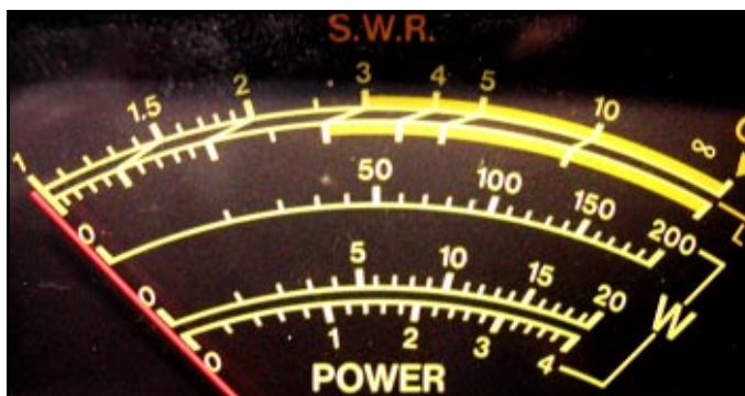
SWR-meter med översta skallinjen indikerande SWR-förhållandet direkt avläsbart.
