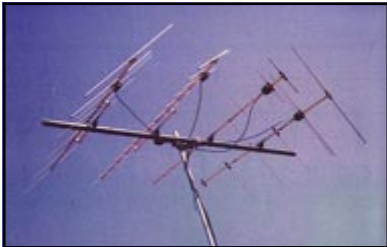
Cirkulärpolariserade antenn bestående av vanliga Yagi-antennerna som kopplats för att åstadkomma cirkulär polarisation.
