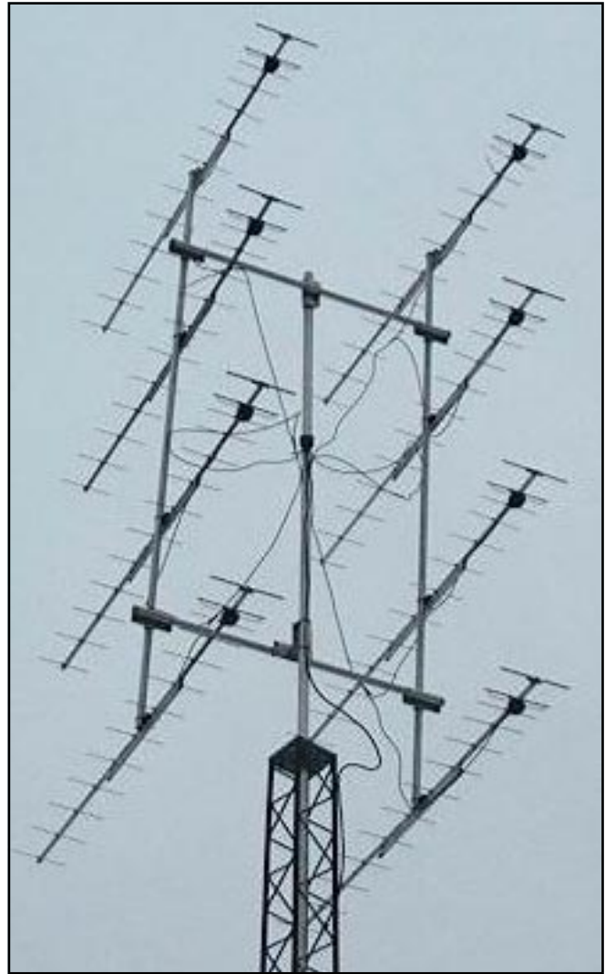
8 stycken 13 element Yagi för 70 centimetersbandet (432MHz). Kallas för 8x13EL70. Cirka 22 dBD.
