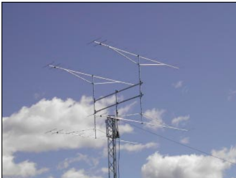
En liten antennarray för EME bestående av fyra stycken 11 elements Yagi. Denna ger endast 19 dB + 18 dB antennförstärkare vid mottagning.
