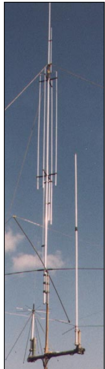
Fabriksbyggd vertikal för 20-10 metersbanden
