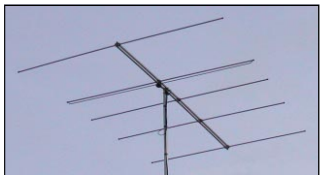
En 5 elements Yagi-antenn för 6 metersbandet (50 MHz)
